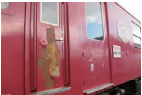
▲経年劣化で塗装が剥がれてしまった動態保存車両の KD951、953。
