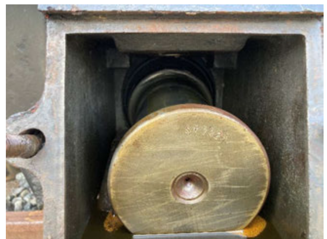
軸受けを抜き出した軸箱です
