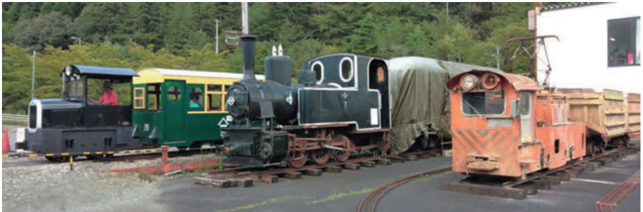
▲いちばん左があしおトロッコ館の主役である足尾銅山のガソリンカー(動態運転)軌間 610mm と、中央は井笠鐵道ドイツ・コッペル社製7号蒸気機関車(静態保存機)軌間 762mm。一番右が、大分鉱業からやってきた日立製作所製 8t 電気機関車と古河鉱業足尾製作所小山工場製のグランビー鉱車 2 両(静態保存)軌間 762mm
