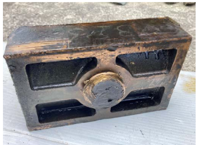
軸受けを抜き出して破損個所を修正しました。
