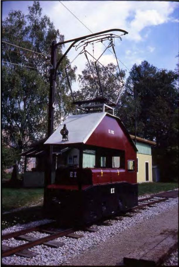
これがお目当てだった 1903 年シーメンス製電機。17.8kW×2 の出力を持つ 9 t 機。全長 4200mm と小さい割には巨大なパンタグラフを振りかざす。'03.9.27
