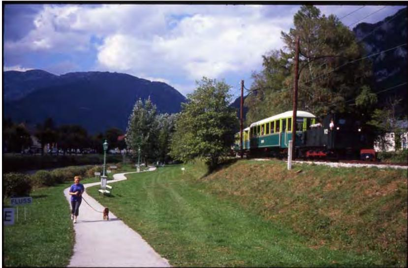
旧鉄聯の古典 DL「V2」(1943年製、16.5t/130PS)に牽かれる客車も1930年製と年代もの。もともとが760mm軌間の工用軌道だっただけに最小曲線は60R、最急勾配は25%とかなり厳しい。架線電圧は直流550V。
