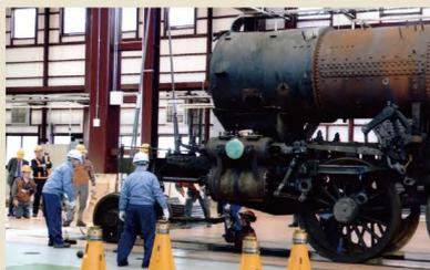
先ず、ピンを抜いて、先輪を外す。2019年4月3日南栗橋SL検修庫。
