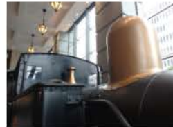
▲復元された金色の蒸気溜まりはFRP製。金属だと腐食の恐れがあるためだという
