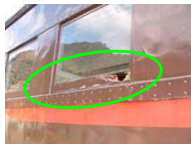
窓と水切りゴム修繕
