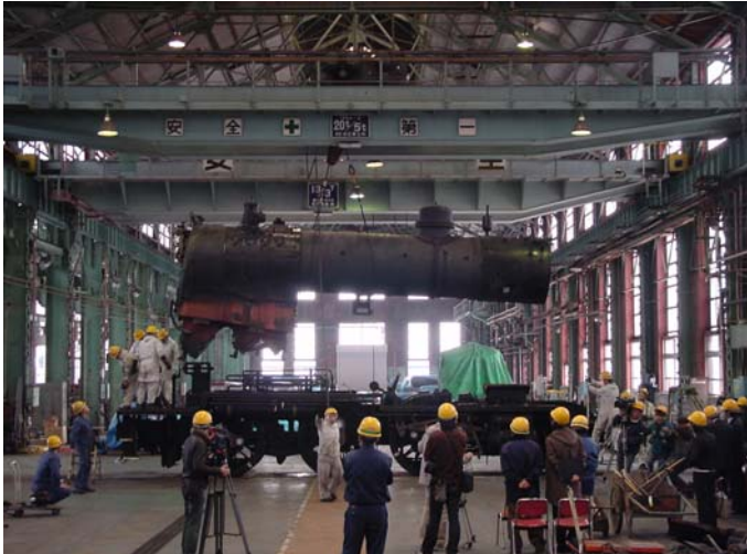
平成 19 年 5 月、報道陣を前にボイラー部と台枠の分離作業が行われた
