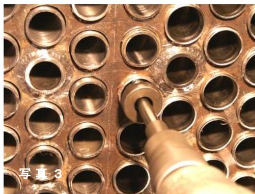
写真3 管端を拡管して鏡板に固定している様子
