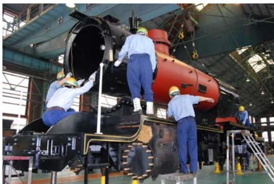
台枠をボイラーに借合わせしている様子。台枠は、SLのいわば背骨であり、車両を安定させるために大変重要な部分。台枠とボイラーの間は少しのずれも許されないため、慎重に作業が進められました。
