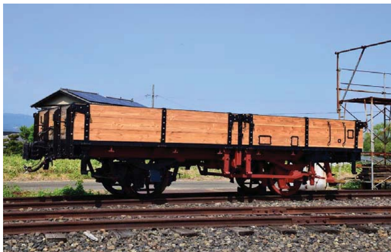
ト15 木板交換修復中 2018年8月4日
