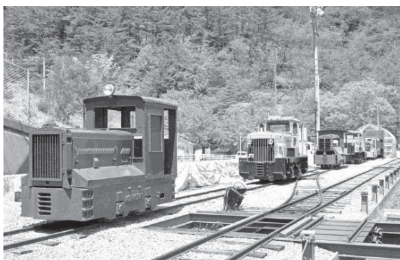
▲一番手前が森製作所製の4トンガソリン機関車。その後は、立山砂防工事専用軌道から来た機関車ほか…
