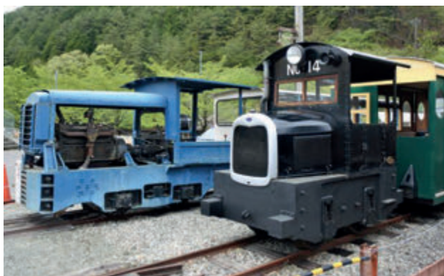
▲右があしおトロッコ館の主役である足尾のガソリンカー。左がフリクションドライブ式の米川鉄工所製の3tガソリン機関車。ともに軌間610mmです。
