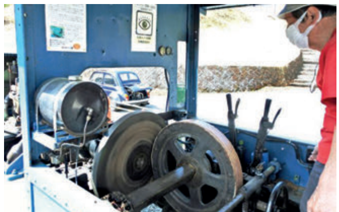
▲エンジンとクラッチを経由してきた円盤(左側)に接続する、縦の円盤(右側)を左右に動かすことによって、前進後進と速度調整をする仕組み。原始的な変速装置です。
