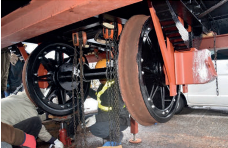
旧関西鉄道鉄製有蓋車復元中 台枠・下回り接合作業 2025/2/11
