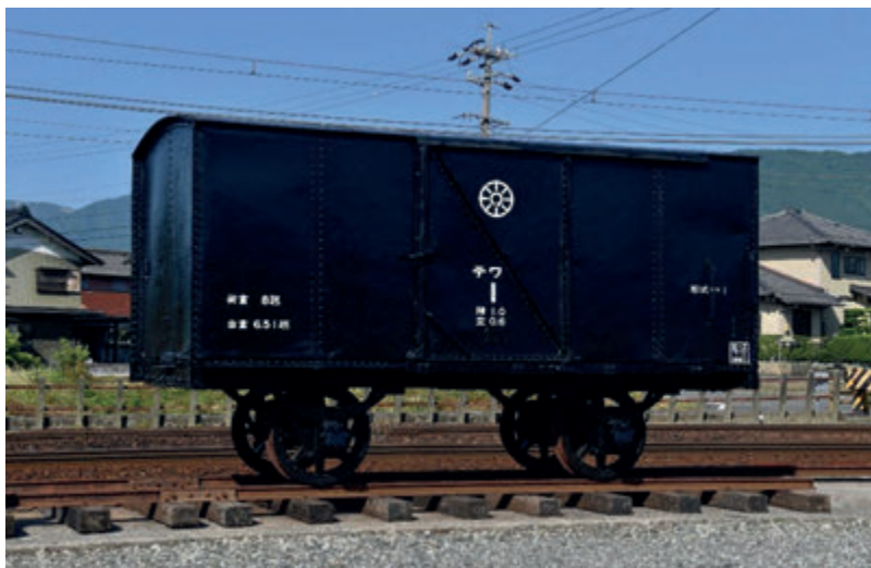
関西鉄道鉄製有蓋車下回り復元完了 2025/6/5
